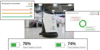
清掃運転中は搭載されたカメラを通じて、リアルタイムにモニタリング可能。PCやスマホにてロボットの状態や異常を確認できます。施工後はレポートをPDF、CSV形式のデータとしてダウンロード可能で、清掃に費やした時間や効率性を確認できます。
