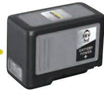
バッテリーパワープラス 36/75 電圧 ● 36V 容量 ● 7.5Ah エネルギー ● 270Wh 重量 ● 2.1kg 寸法 ● 長さ167 ×幅88×高さ118mm
