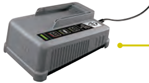
急速充電器バッテリーパワープラス 18/60 充電時間 ● 18/3.0 ⇒ 60分 出力電力 ● 6A 充電 器用電源 ● 100-240V/50-60Hz 重量 ● 0.9kg 電源 コード ● 1.2m 寸法 ● 長さ192×幅137×高さ81mm
