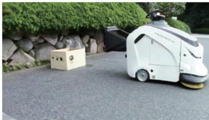
走行中にバッテリーレベルが低下すると、ステーションに戻り、自動的に充電を行います。充電完了後、走行ルートの続きから再開。またゴミ捨て場を認識するので、ゴミ捨て作業の自動化が可能です。
