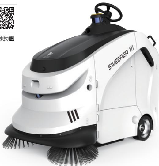
くうかんの「GAUSSIAN」(ガウシアン)シリーズは、床面の除塵、洗浄の全自動化を具現化した業務用清掃ロボットである。本シリーズに今回、屋外などの除塵を可能にしたスイーパーがラインナップされた。本機は、起動した地点を起点に、自動的にマップを作成。ステップを降ろし、搭乗しながら自動生成されたマップに沿って走行すれば、精度の高いエリアマップも作成できる。また、時間をプログラムすると、検知させたゴミ箱への自動ゴミ捨ても実現可能。電力低下した際は、ステーション(別途販売)に帰還し、自動充電後、清掃を再開する。
